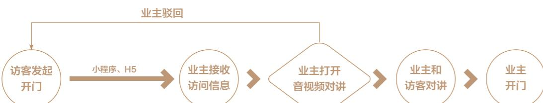
图：音视频开门完整流程
